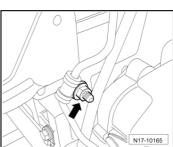
Préparer l'outil ouverture 14 comme indiqué pour maintenir l'ajutage de raccordement de la conduite d'alimentation d'huile,
