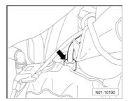
Brancher la fiche -2- au transmetteur de position de l'actionneur de pression de suralimentation -G581- et fermer le manchon de protection contre la chaleur.Brancher le l
