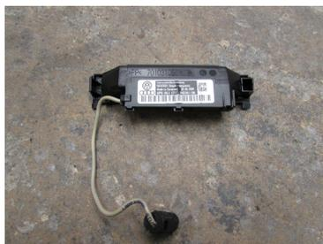
8K0 973 754 (module 8P0 951 177)(connecteur détecteur de mouvement)
