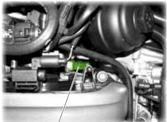
Contacteur de pression d'huile pour contrôle de la pression réduite F378
