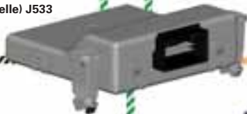
Interface de diagnostic du bus de données (passerelle) J533
