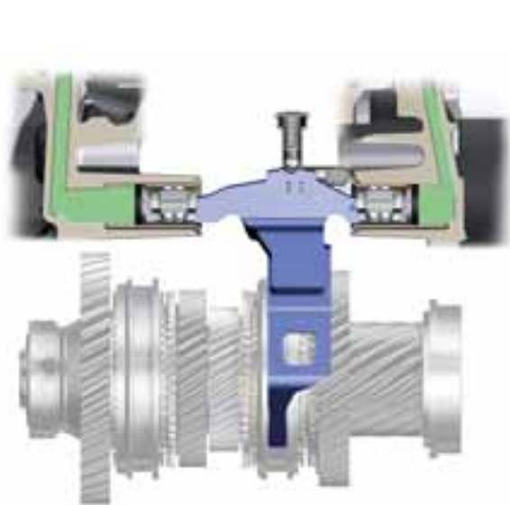
Fourchette de commande exempte de pression au point mort
