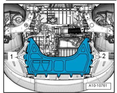
Véhicules avec moteur 1,8 l FSI
