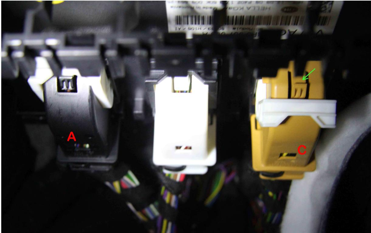
Vous pouvez débrancher les 3 et retirer déclipser complètement la centrale pour avoir un peu plus de place pour travailler: On va attaquer les choses sérieuses.
